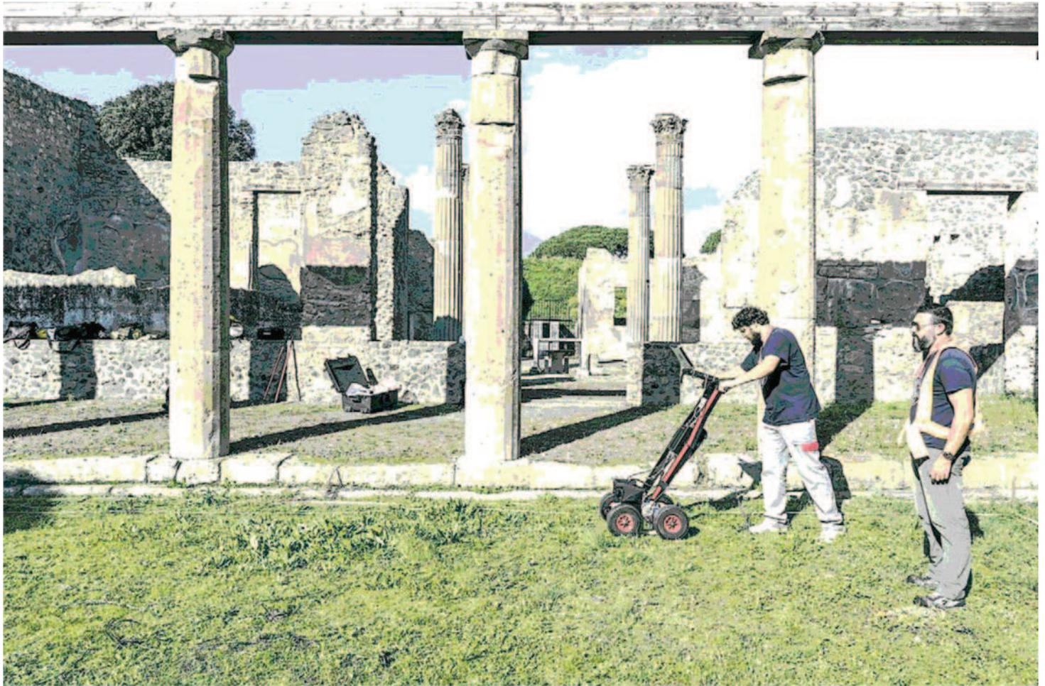
Segreti sotterranei Si esplora il sottosuolo di Pompei con un georadar
