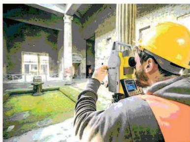
**Rilievo digitale** Un tecnico effettua le misure all'interno di un edificio di Pompei. Le immagini di queste pagine fanno parte del progetto Pompei Intra-Extra del fotografo Pierluigi Giorgi
