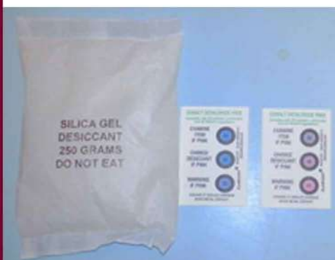
Gel di silice e indicatori di UR per la stabilizzazione e il controllo dell'U.R.
