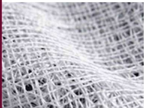
Rete quadriassiale in fibra di vetro con caratteristiche di alta resistenza
