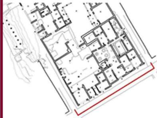
Il fronte su via dell'Abbondanza rimarrà esposto alla pioggia battente
