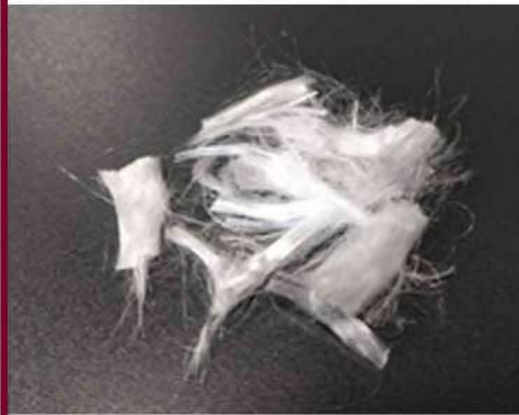
Micro-fibre ausiliarie polipropilene multifilamento (lunghezza 18 mm)
