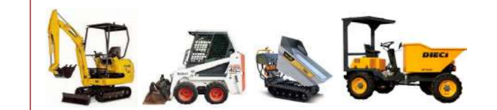
Movimento di terra interno: miniescavatore - bobcat - motocarriola - dumper
