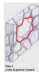
Fase 3 crollo di porzioni murarie
