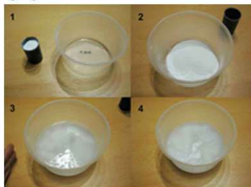
Preparazione del Gel supportante a base di laponite
