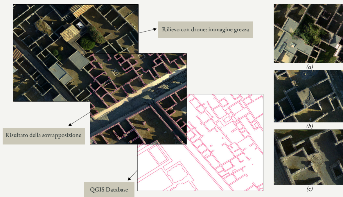
Figura 14. Sovrapposizione ortofoto georeferenziate con mappatura dell'alzato archeologico da database QGIS (a sinistra). Esempio di possibili criticità (a destra): presenza di vegetazione (a), guaine danneggiate (b), elementi in caduta (c).
