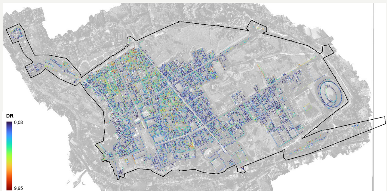
Figura 9. Rappresentazione della Difettosità Relativa (DR) nel caso di Struttura Muraria di un Paramento Murario
